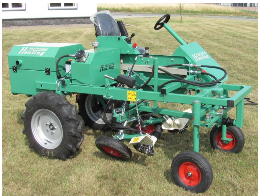
Selbstfahrender Rankenschneider für Damm-Kulturen (Quelle: www.heuling.de )
