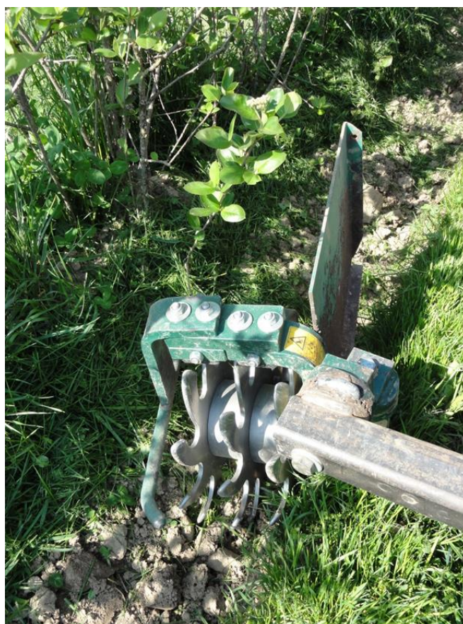
3er Rollhacke ohne Fingerhacke - Der Hackeffekt sowie die Flächenleistung und der Kraftaufwand ist etwas geringer.
