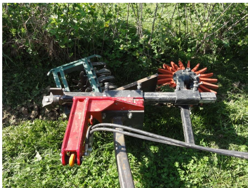
4fach Rollhacke mit Fingerhacke - Hohe Flächenleistung erfordert hohe Fahrgeschwindigkeit, bei sehr hohem Kraftaufwand und starkem Verschleiss der Lager.
