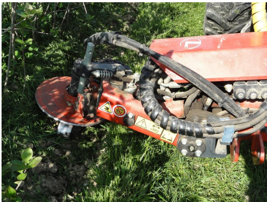
Einseitiges Krümler- / Kreiselgerät im Frontanbau, bestens bekannt aus dem Obstbau
