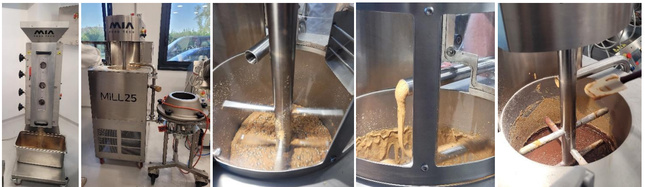
Abb. 8 Herstellung von Pasta/Crema in Bildern v.l.n.r.: Geröstete Haselnüsse werden schonend gemahlen, Maschine zur Herstellung von Pasta/Crema, Mehl wird im Rührbehälter mit 3'000 Metallkugeln cremig verrieben, für eine gute Durchmischung werden flüssige Anteile, die sich im unteren Teil der Schüssel sammeln, mit einem Rohr wieder von oben auf die Masse geführt, mit Zugabe von Cacao und Zucker entsteht eine Gianduja-Crema.
