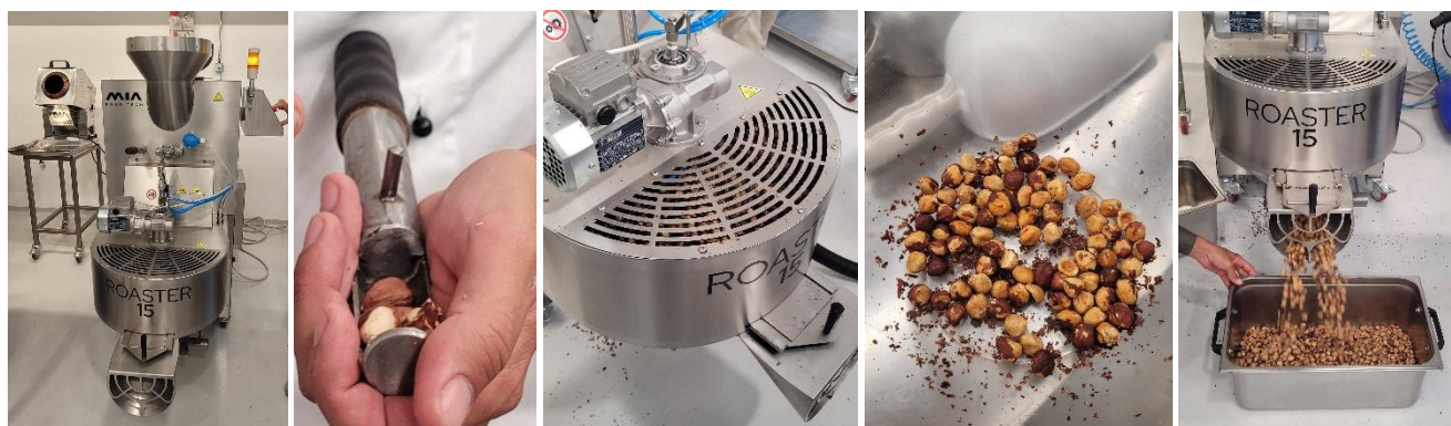
Abb. 6 Röstvorgang in Bildern v.l.n.r.: Röstmaschine, Rohr für Musterentnahme zur visuellen Röstgradkontrolle, Trommel zur Entfernung der Nusshäutchen, Augenschein der gerösteten und teils enthäuteten Haselnüsse, bereit zur Weiterverarbeitung.
