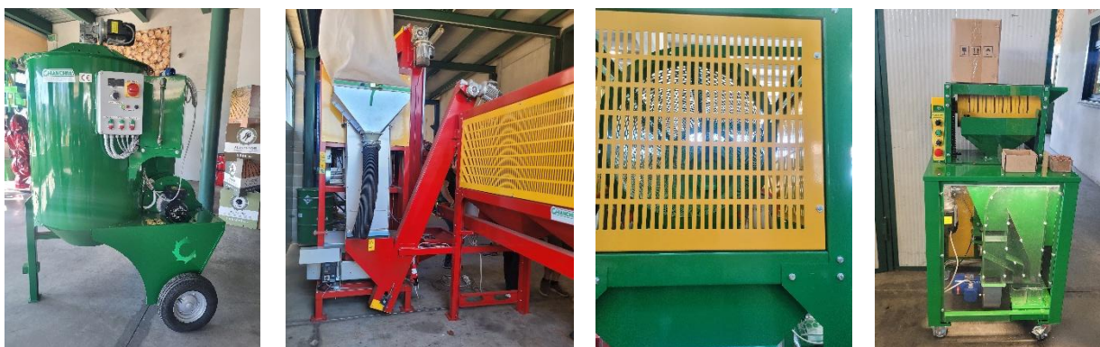
Abb. 1 Von der Trocknung bis zur Kalibrierung (v.l.n.r.): Haselnusstrockner für Kleinmengen (Bild 1), Knackgerät (links im Bild), anschliessend Container mit Kalibriertrommeln (Bild 2), mehrere aneinandergereihte Kalibriertrommeln mit unterschiedlicher Perforierung zur Sortierung von grösseren/kleineren Nüssen (Bild 3), Kleinkalibriergerät knackt/sortiert 280gr. Nüsse/Minute (Bild 4).
