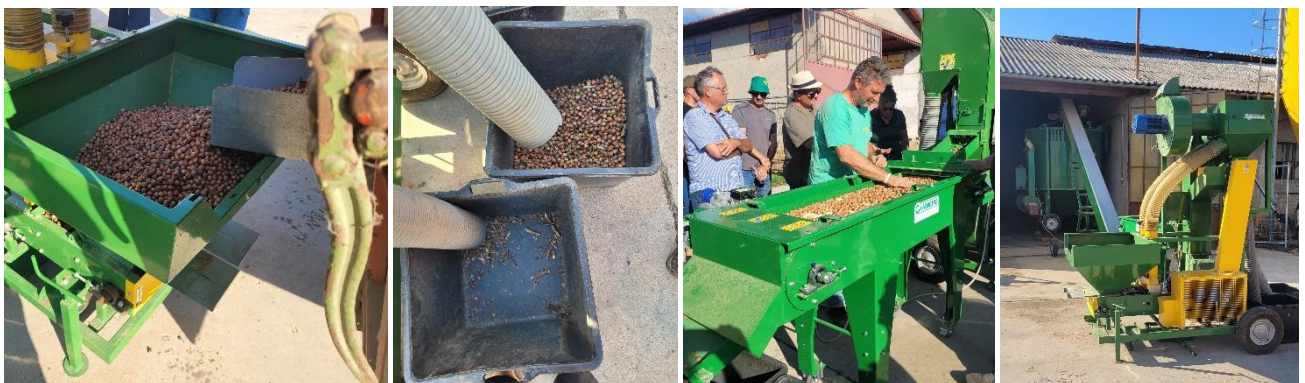
Abb. 3 Sortier- und Trocknungslinie auf dem Betrieb Filipi Marita (v.l.n.r.): Erntegut kommt vom Anhänger in den Vorreiniger (Bild 1), vor dem Förderband werden zu schwere Teile in den vorderen, zu leichte in den hinteren Behälter aussortiert (Bild 2), Haselnüsse laufen über Förderband, wo die händische Feinreinigung erfolgt (Bild 3), anschliessend werden Nüsse in die Trocknungstrommel befördert (im Hintergrund auf Bild 4).
