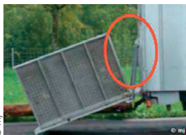
Nicht zulässiger Abstand zw. Fahrzeug und Rampenseitenschutz
