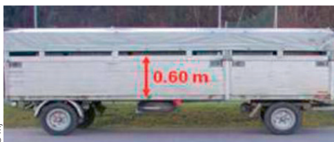
Anhänger für Kleinvieh; Nicht perforierte Wand
