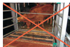
Unzulässige Einzelstange bei Viehtransport
