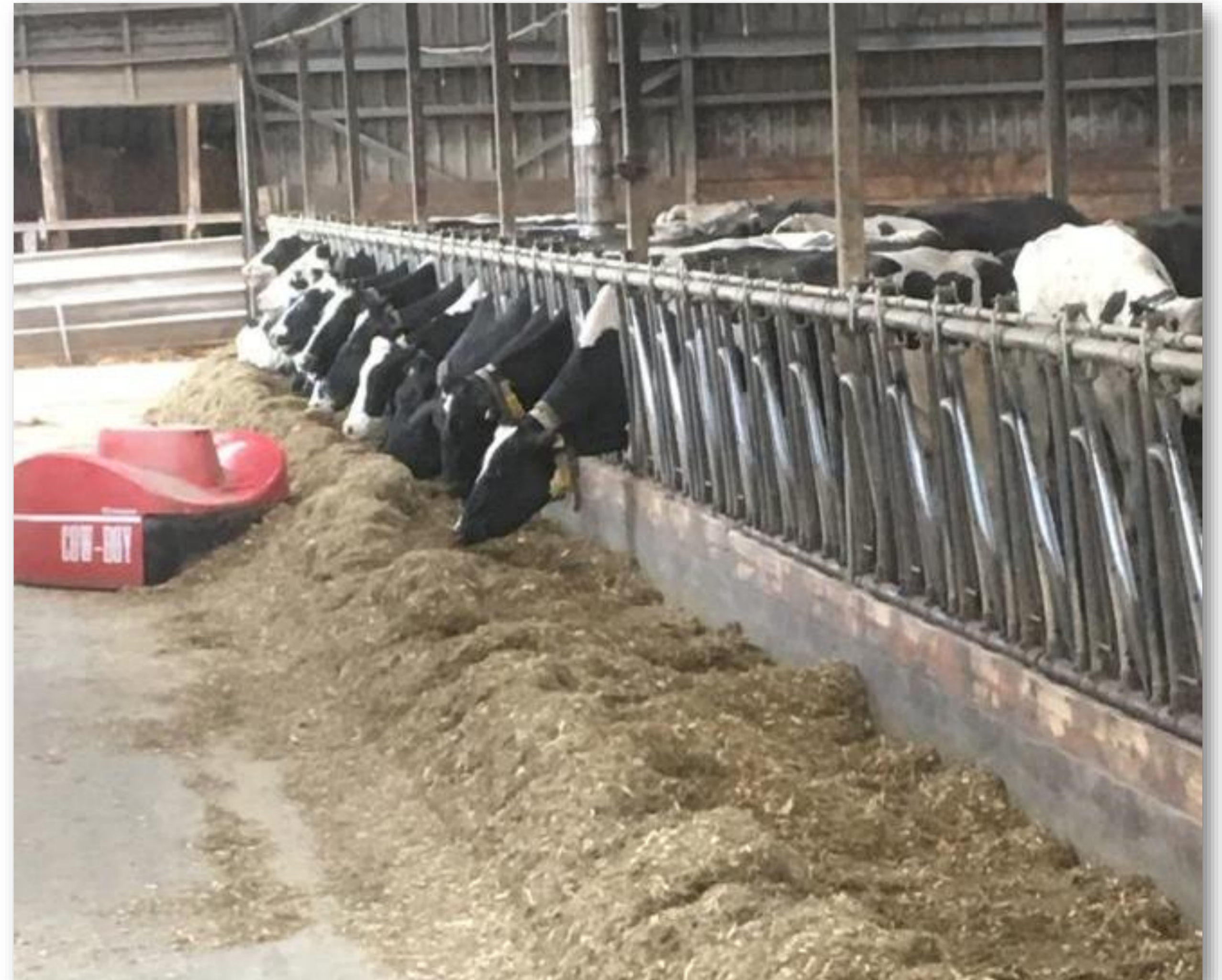
Abbildung 2: Der Roboter schiebt das Futter und lockt die Tiere an.
