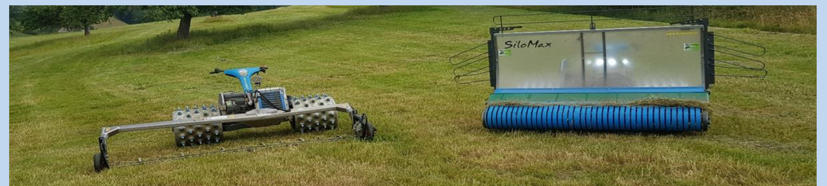
Brielmaier Motormäher mit einem Doppelmesserbalken und einem SiloMax
